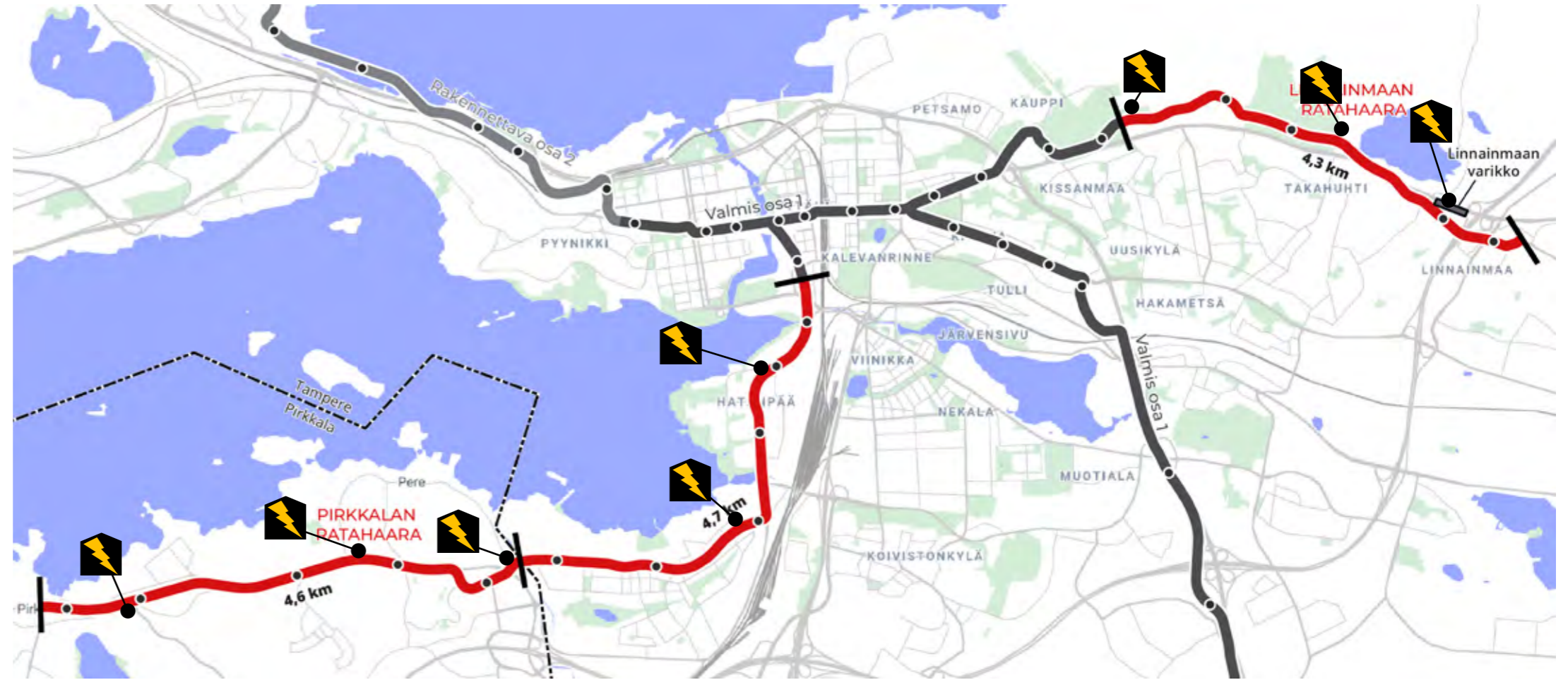
Kuva 56. Pirkkala-Linnainmaa sähkönsyöttöasemien sijoittuminen.
